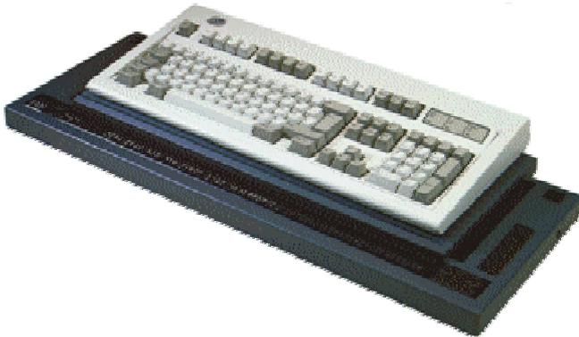
Abbildung 4: Konventionelle Tastatur kombiniert mit Brailletastatur für blinde Menschen (Quelle: Baum)
